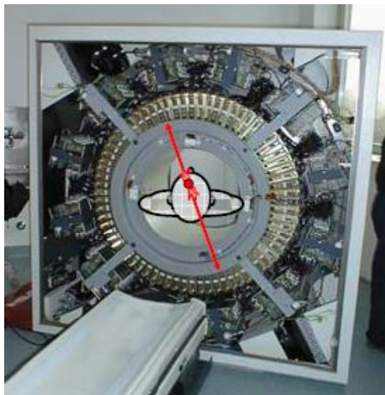
Abbildung 6: Detektorring des PET Gerätes des Institutes für Nuklearmedizin der Universitätsklinik für Innere Medizin in Graz
