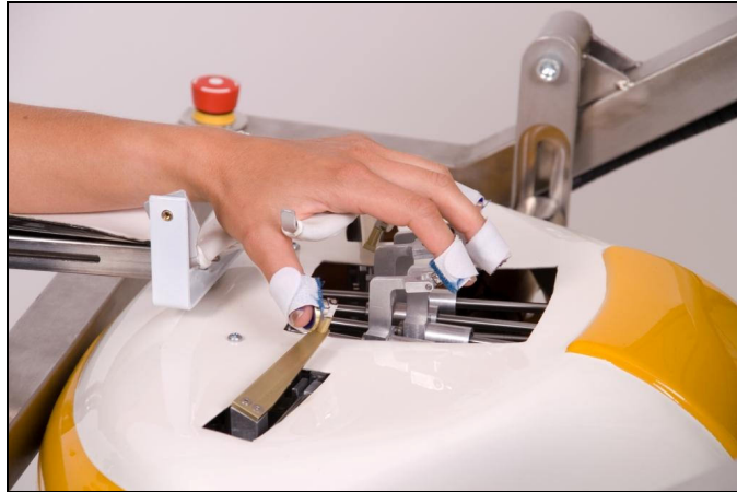
Abbildung 14: Mechanotronisches Finger-/ Handrehabilitationsgerät [Quelle: Amadeo ©, Fa. Tyromotion, www.tyromotion.com ]
