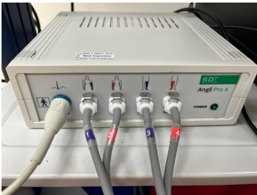
Abbildung 4: AngeE™ SOT (Medical Systems) mit den Ausgängen für Channel 1-4= CH1-4, sowie links für die EKG-Sensoren
