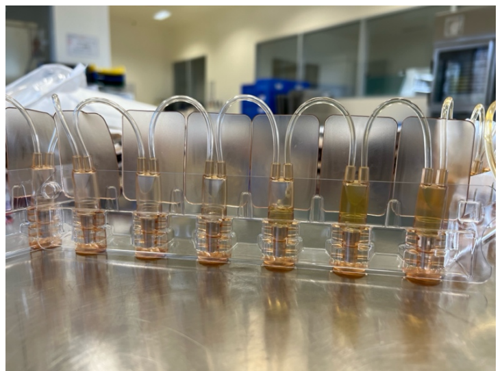
Abbildung 10: Befüllung der einzelnen Applikatoren (die ersten zwei Applikatoren von rechts sind gefüllt und der dritte Applikator wird gerade gefüllt)
