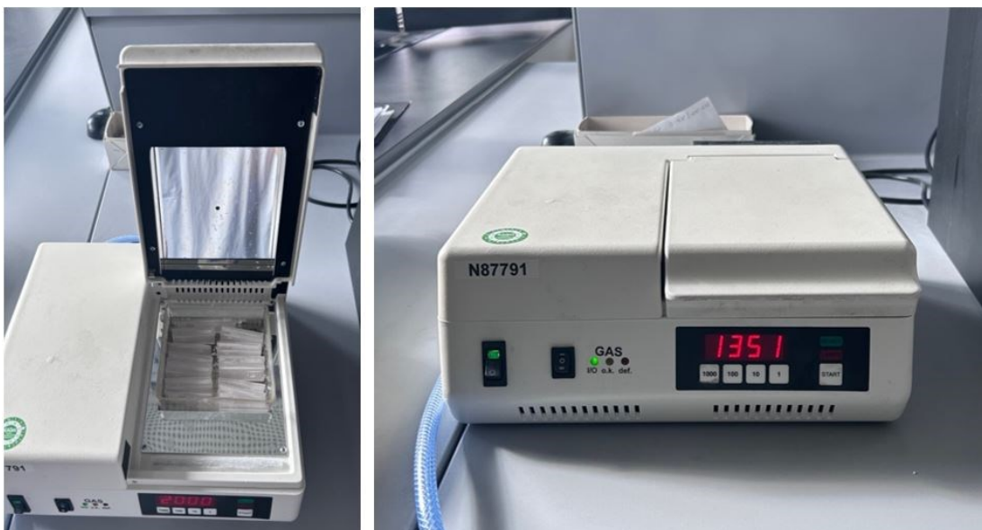
Abbildung 25: Polymerisation durch Lichtgerät mit 2000 Blitzlichtschlägen
