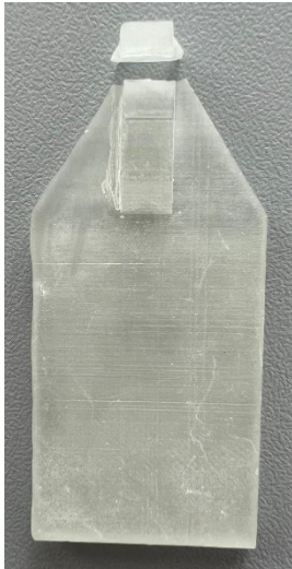
ABBILDUNG 44 LATERALE ÖSE BRUCHSTELLE
