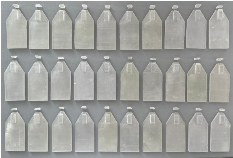
ABBILDUNG 48 LATERALE ÖSE PARALLEL GEDRUCKT, BRUCHSTELLEN
