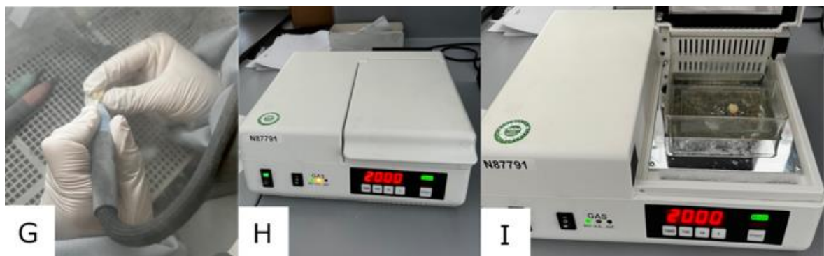
Abbildung 11: G: Abstrahlen mit 50qm Glanz - H: Otoflash G171 - I: Krone in Lichthärtegerät
