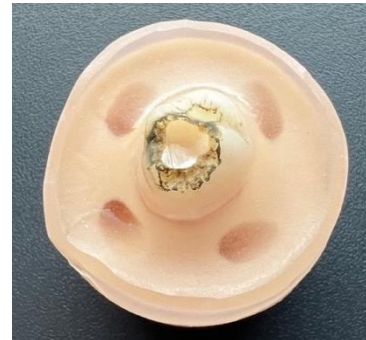
Abbildung 20: Grauer Staub auf einer Tetric CAD Probe
