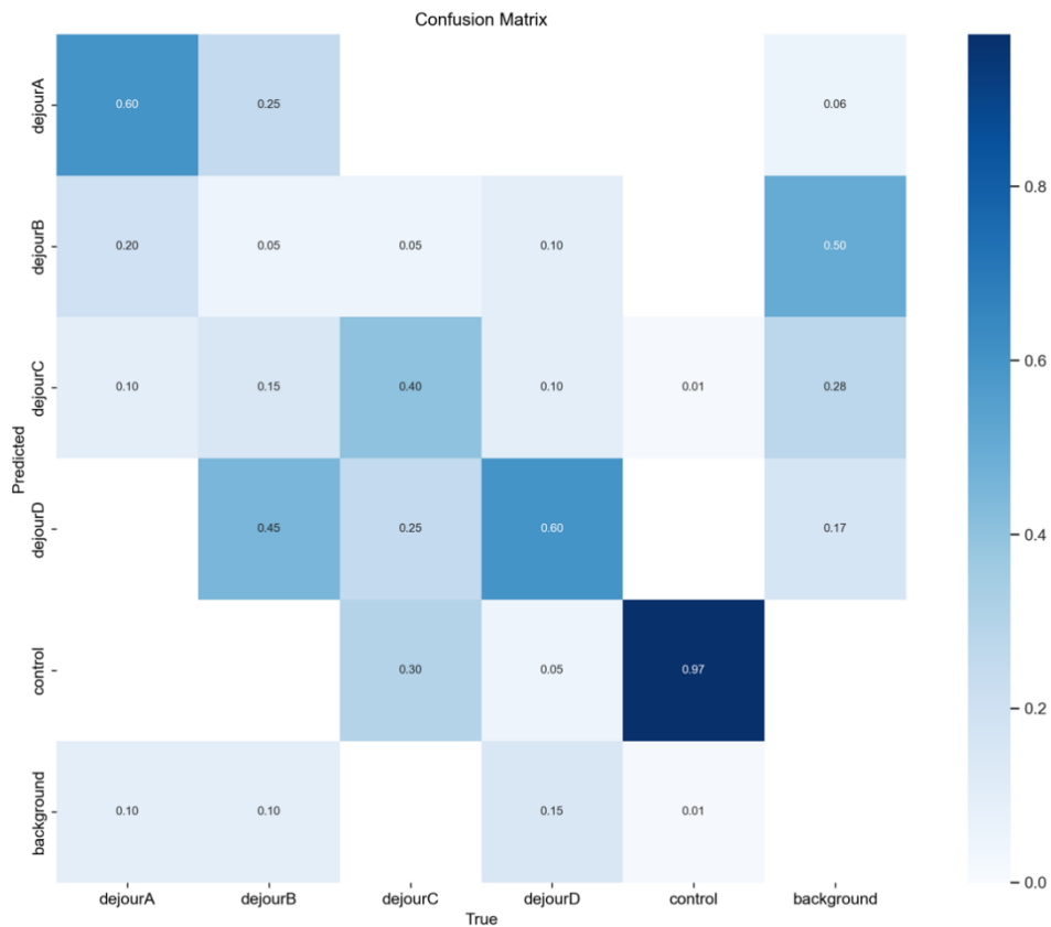
Abbildung 3 Confusion Matrix YOLOv5 Test mit 5 Vorhersagewerten (Dejour A-D sowie N)
