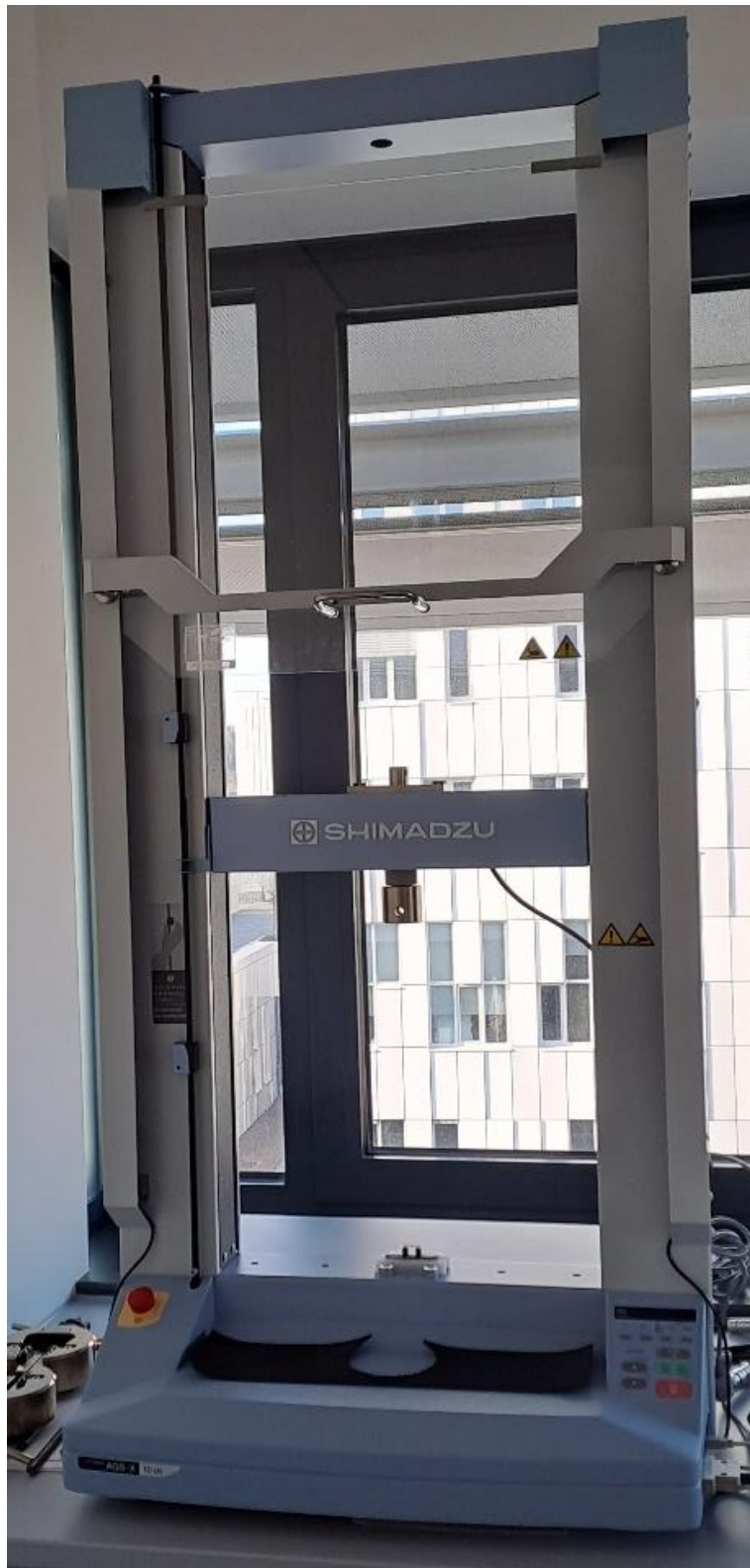
Abbildung 19: 3-Punkt-Biegeversuch: Shimadzu (Autograph AGS-X 10kN)
