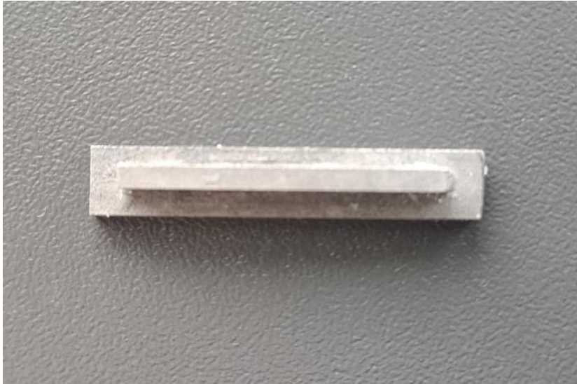
Abbildung 12: Stanze von unten
