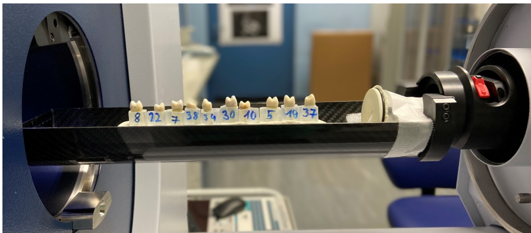
Abbildung 11: Fixiertes Carbonbett im Micro CT
