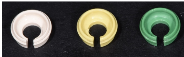
Abbildung 29: Novaloc® Retentionseinsätze nach 10.000 Einsetz- und Entnahmezyklen Quelle: eigene Aufnahme
