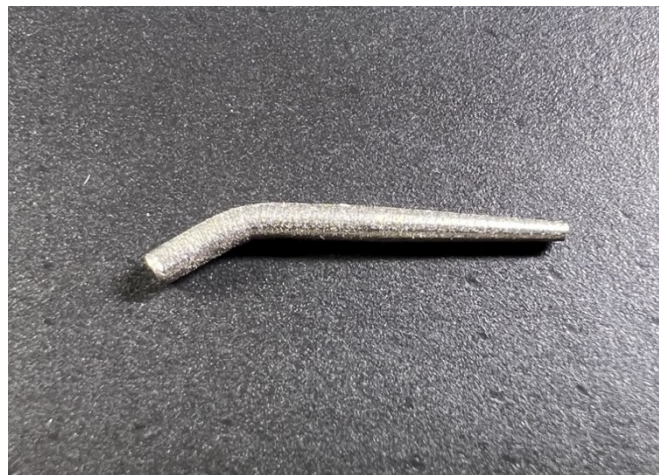
Abbildung 19: Chrom-Kobalt-Stift nach der Frakturbelastung
