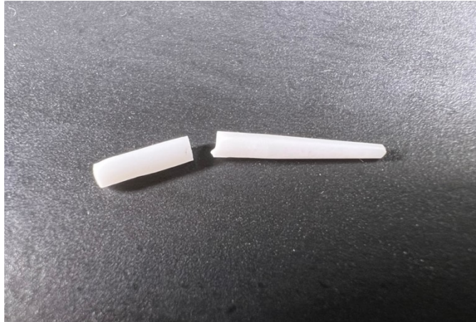
Abbildung 20: Zirkonoxid-Stift nach der Frakturbelastung
