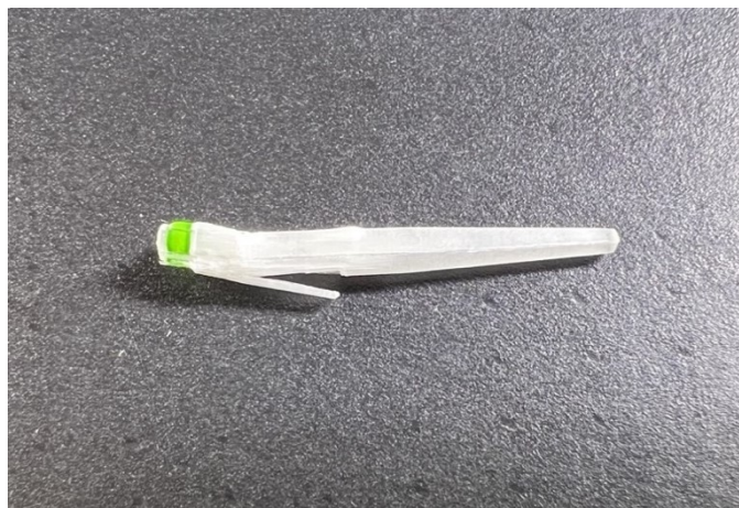
Abbildung 21: Quarzfaser-Stift nach der Frakturbelastung
