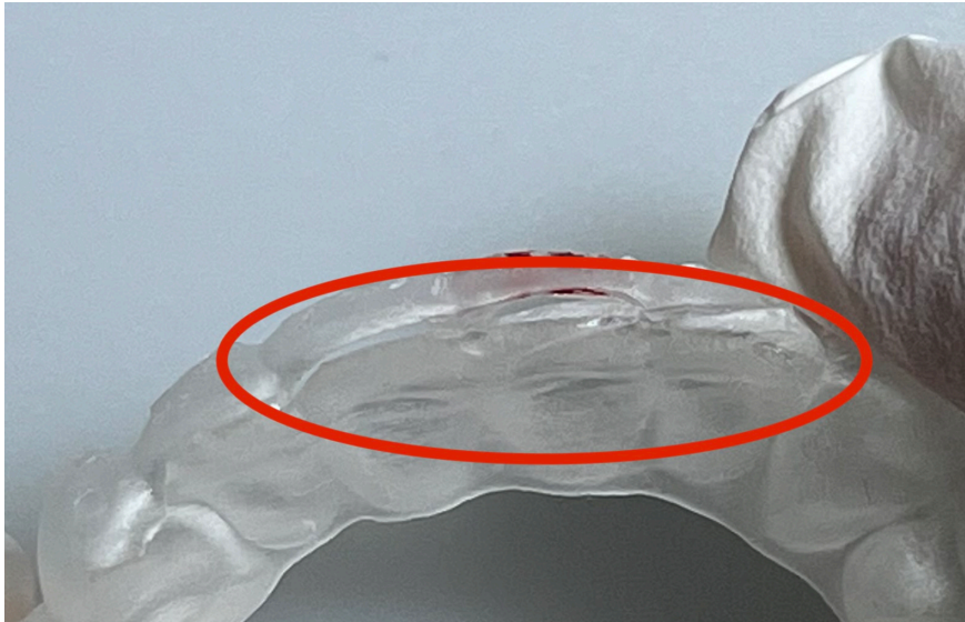
Abb. 45: Riss entlang der Inzisalkante bei Schiene Nr. 10, nur sichtbar bei Kompression der Schiene im Frontzahnbereich
