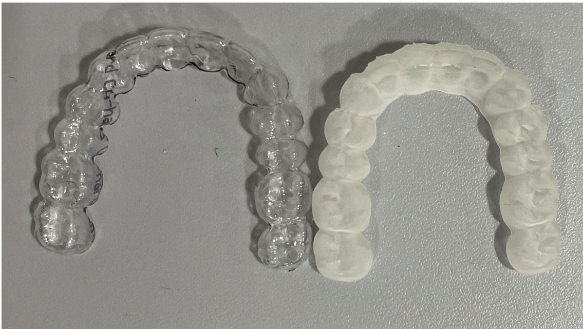
Abb. 41: Größenunterschied zwischen den tiefgezogenen Alignern (li.) und den 3D-gedruckten Folien (re.)
