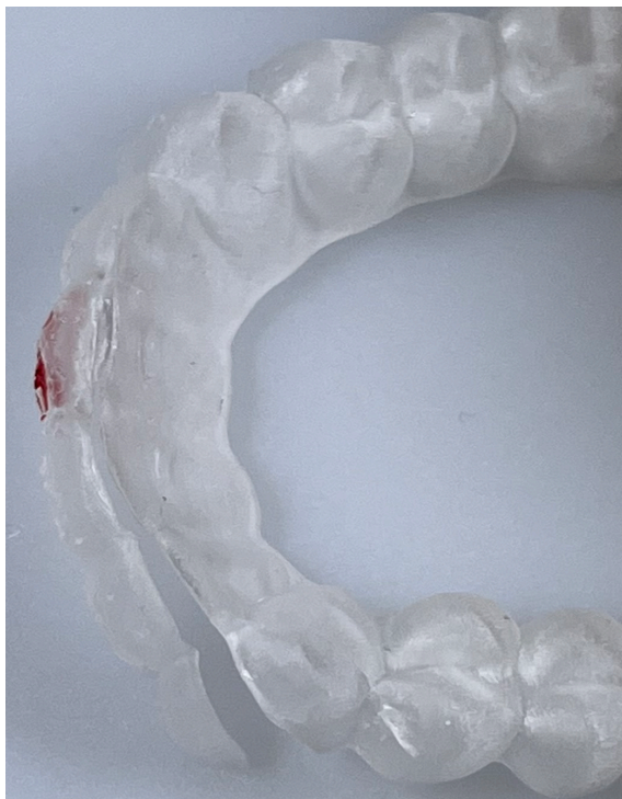
Abb. 42: Rissverlauf der 1. Schiene
