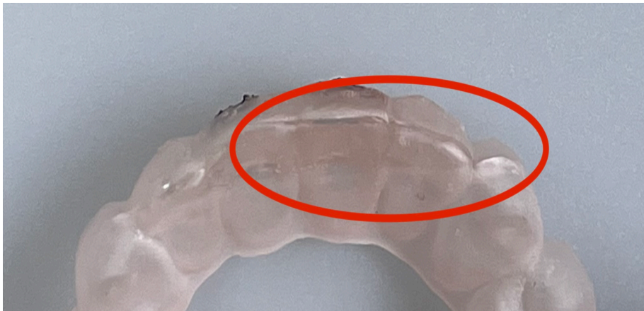
Abb. 43: Rissverlauf entlang der Inzisalkante - Schiene Nr. 14
