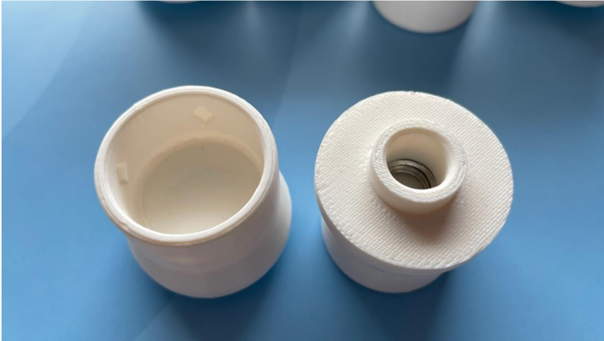
Abb. 7 Probenbehältnis (links die zu befüllende Oberseite, rechts Unterseite zur Befestigung an der Messapparatur)
