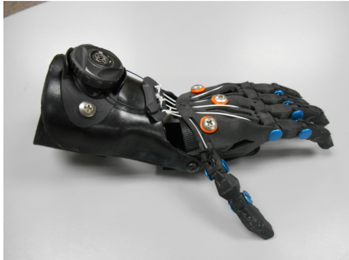
Abbildung 27: 3D-gedruckte Handprothese: Cyborg Beast (104)
