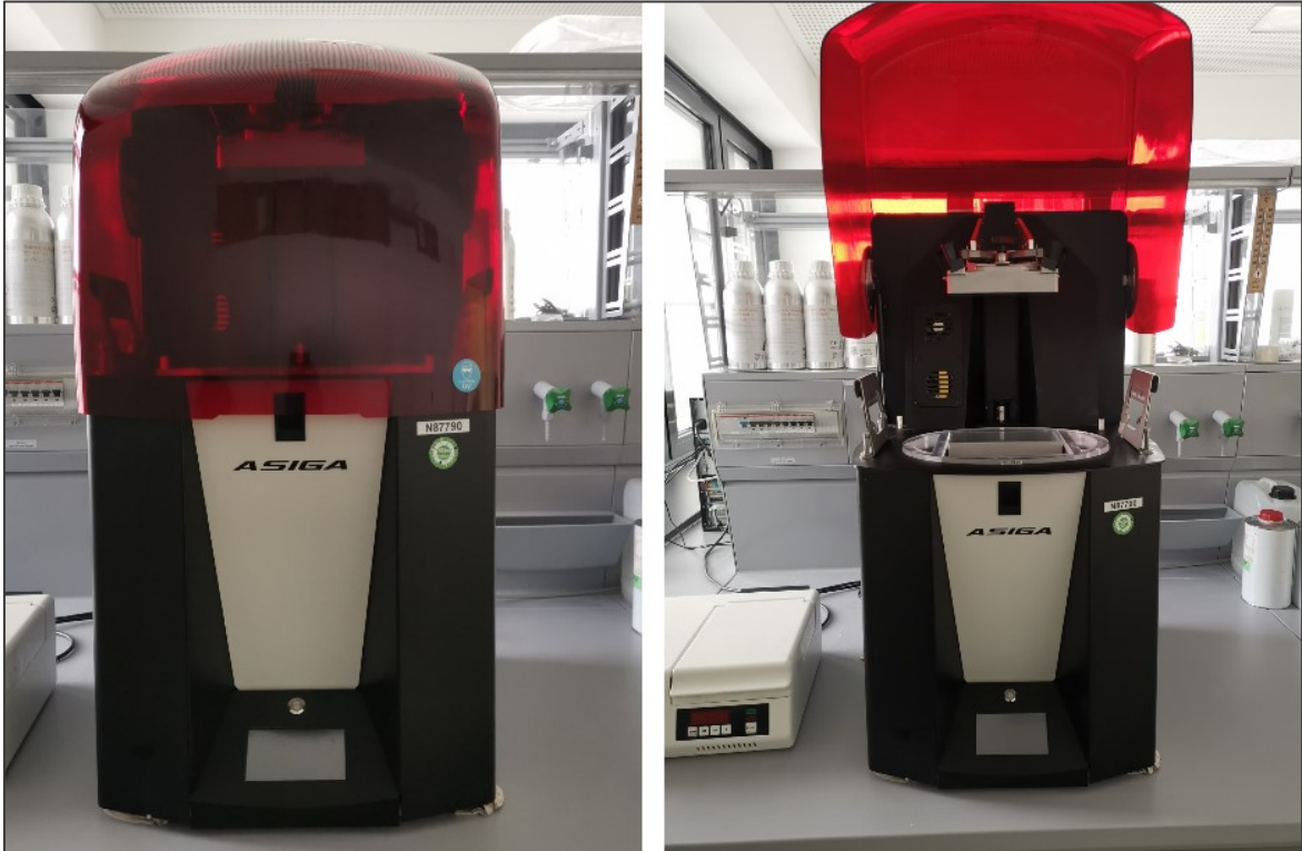
Abbildung 11 3-D Drucker Asiga Freeform
