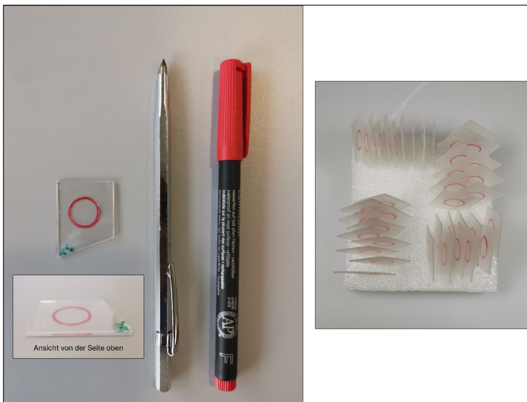
Abbildung 24 Markierung des Untersuchungsfeldes: links - markierte Duran® Probe auf dem Musterplättchen mit Reißnagel und Filzstift; rechts – markierte 3-D gedruckte Proben in der Schaumstoffplatte.
