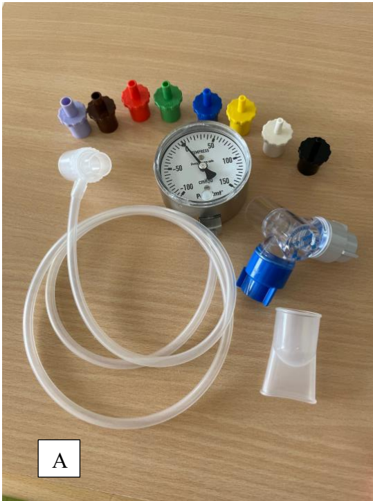
Abbildung 10: PEP/ RMT™ Gerät (A), Einstellung zu Messung des P_{i_{max}} (B) Quelle: Foto Michaela Schöfer
