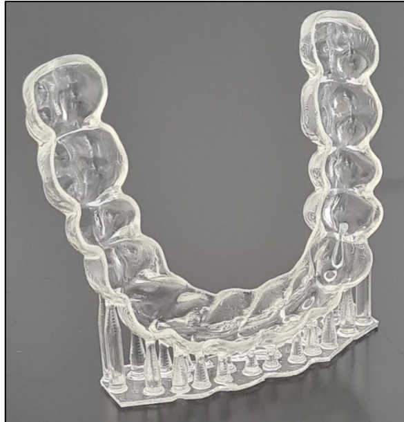
Abbildung 34: Gedruckter Aligner mit Supporter, die kreisrunden Formationen im Aligner sind keine Blasen, sondern die durchscheinenden Enden der Supporter
