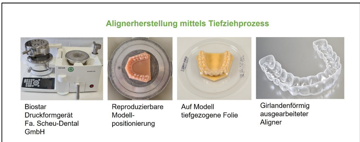
Abbildung 26: Alignerherstellung mittels Tiefziehprozess
