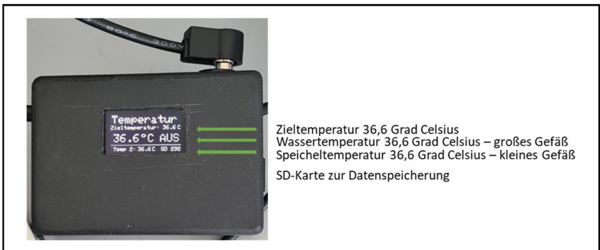
Abbildung 51: Messverstärker für Tempuraufzeichnung mit integrierter SD-Karte
