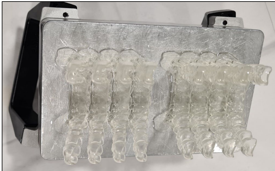
Abbildung 33: Gedruckte Aligner auf Bauplattform
