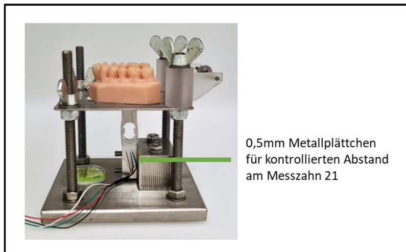
Abbildung 46: Die Messapparatur – mit 0,5mm Metallplättchen für die Verlagerung des Messzahnes
