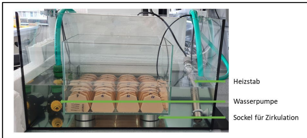
Abbildung 52: Simulierte in vivo-Lagerung – das Heizsystem
