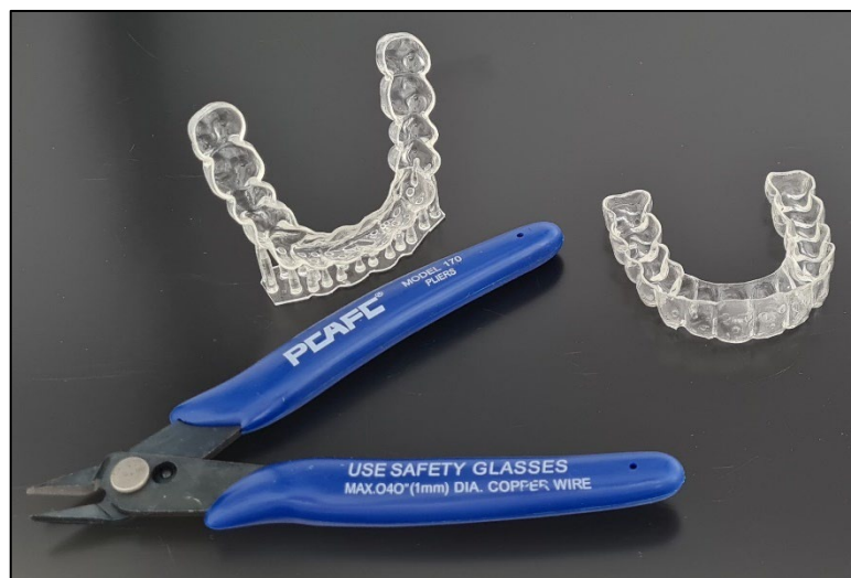
Abbildung 35: Flacher, spitzer Mini-Seitenschneider zur Entfernung der Supporter beim gedruckten Aligner
