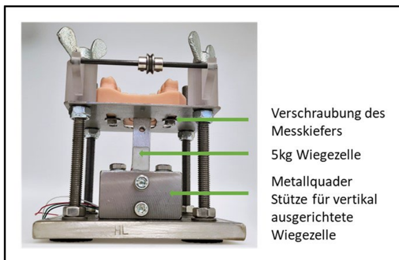
Abbildung 45: Die Messapparatur – Ansicht von hinten
