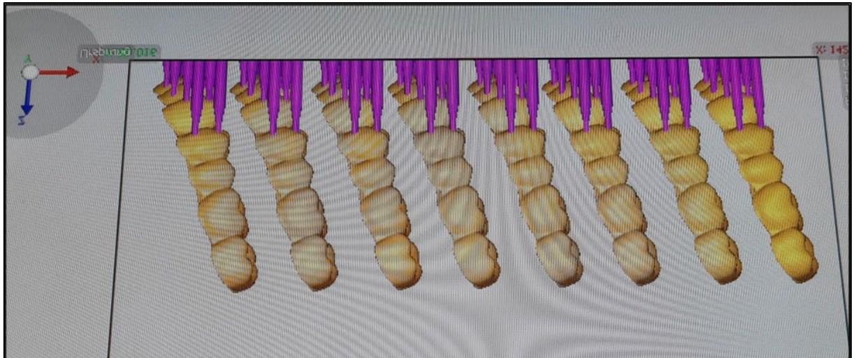
Abbildung 30: Digitale Aligner mit Supporter (violett) auf Bauplattform positioniert
