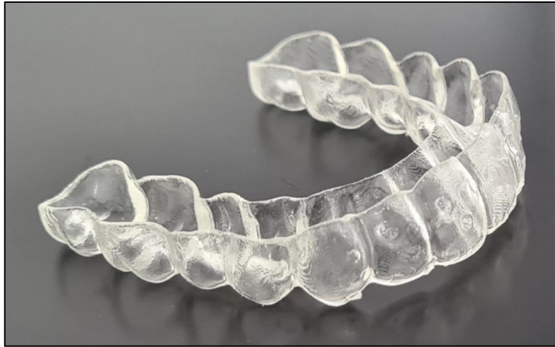
Abbildung 36: Gedruckter Aligner, die Noppen auf der Aligneraußenseite entstehen durch die Supporter, der Aligner ist an seiner Innenseite glatt
