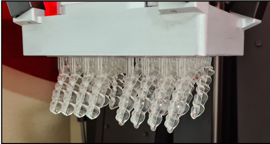
Abbildung 32: Gedruckte Aligner auf Bauplattform im Drucker Asiga Freeform PRO2
