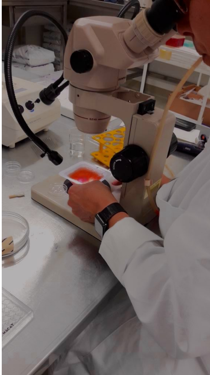
Abb. 10: Überführung der Tumorspheroide auf ein kultiviertes CAM-Modell. Über das mit der Pipette in Verbindung stehende Mundstück können die Proben sanft angesaugt werden. Der feine Durchmesser der Pipette erlaubt dann eine gezielte Platzierung im Silikonring.
