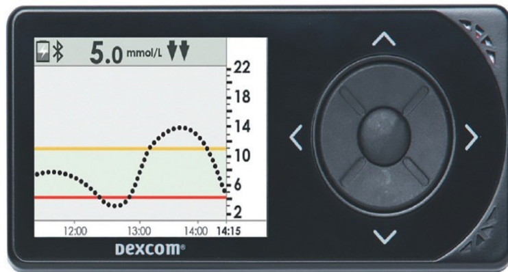
Abbildung 5: CGM zeigt den aktuellen Glukosewert, den Gradienten der Glukosekonzentration, die Alarmschwellen und die Änderungsgeschwindigkeit (49)
