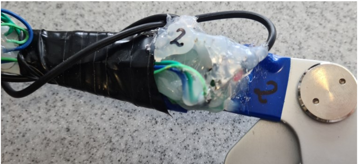
Abbildung 67 – Chip 2 wurde mit heißen Plastifizierungsmittel fixiert
