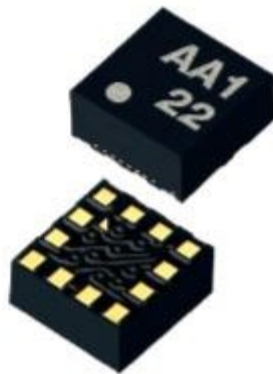
Abbildung 61 – der angewendete KX122-1037 Drei-Achsen Beschleunigungssensor
