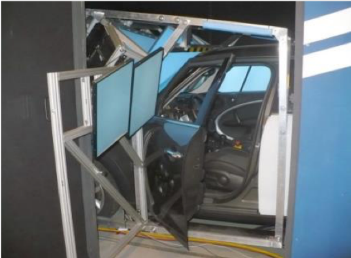
Abbildung 10: Ein zum Fahrzeugsimulator umgebautes Auto (Foto TU Graz)
