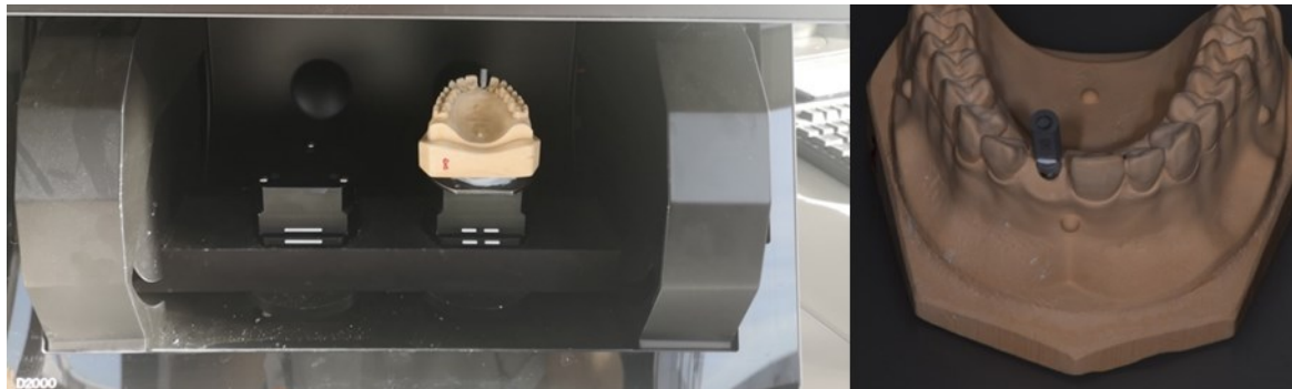
Abb. 9: Laborscanner D2000® von 3Shape (links) und Modell mit Scankörper (rechts)
