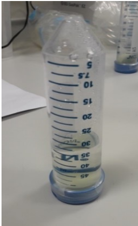
Abbildung 21: Falcon®-Tube mit PMMA-Prüfkörper in PBS-Puffer
