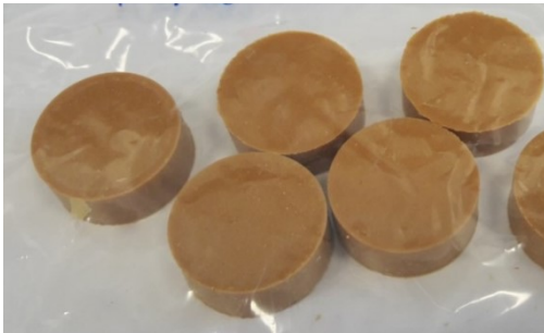
Abbildung 14: PMMA-Prüfzylinder mit 2,66 g NLAB
