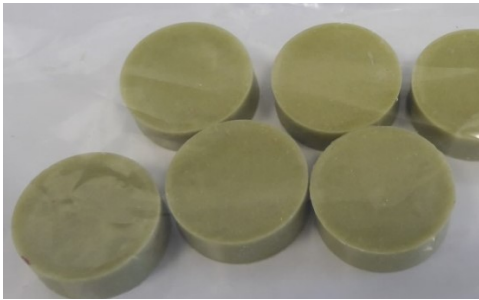
Abbildung 13: PMMA-Prüfzylinder mit 0,2 g NLAB
