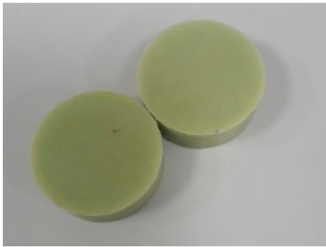
Abbildung 11: Mikrobiologische PMMA-Prüfkörper mit 0,2 g NLAB
