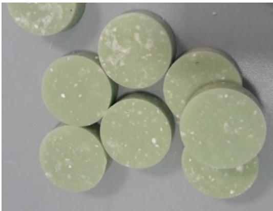
Abbildung 17: PMMA-Prüfzylinder mit 10,5 g Voriconazol ®
