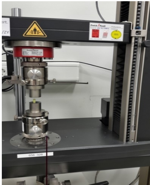
Abbildung 14: Druckfestigkeitsprüfung nach ISO 5833
