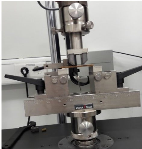
Abbildung 15: Biegefestigkeitsprüfung nach ISO 5833
