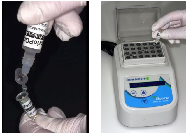
Abbildung 7: sechs Tropfen "Solution A" ins Probenröhrchen applizieren und anschließend in den Mini-Heizblock bei 95°C für 6 Minuten
