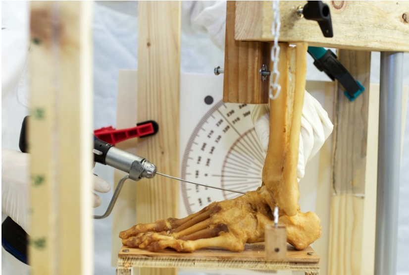
Abb. 7: Messdraht Ein Kirschner-Draht wurde in sagittaler Richtung in das caput tali eingebracht.
