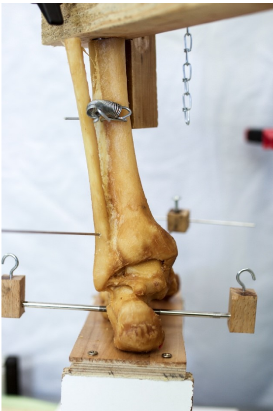
Abb. 4: Syndesmose Eine Metallfeder zwischen Tibia und Fibula simuliert die Spannung der Syndesmose.
