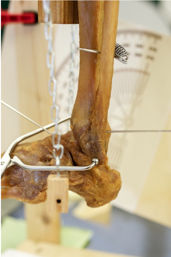
Abb. 11: Positionierung der Klemme Die Klemme wurde mittig auf Innen- und Außenknöchel positioniert.
