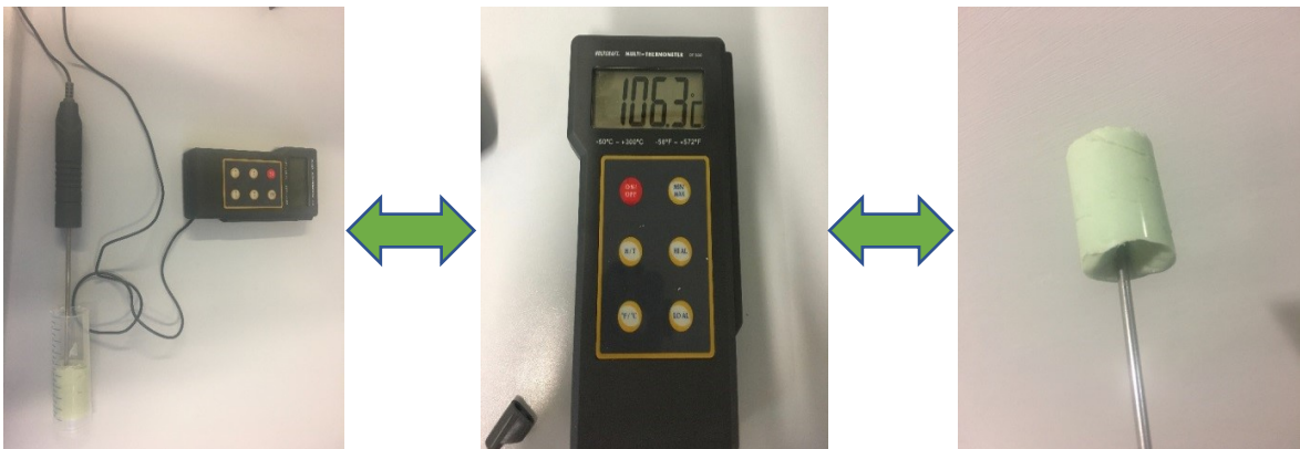
Abbildung 23 Versuchsaufbau zur Messung der Temperaturentwicklung im Knochenzement (Copal Spacem ® )
