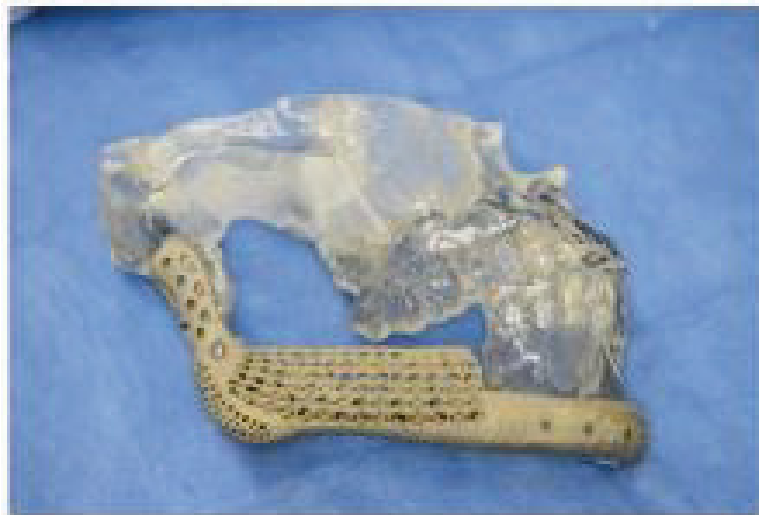
Abbildung 10: Kunststoffmodell mit gesintertem Titanimplantat 10
