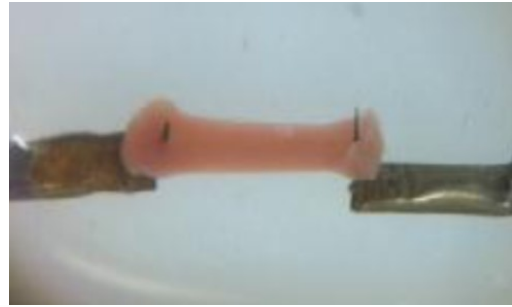
Abbildung 4: Isolierter Trabekel auf Nadeln fixiert, Blick durch das Mikroskop
