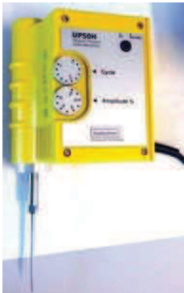
Abbildung 14. Ultraschallprozessor (UP50H Fa Hielscher, BRD ). Eigenes Foto.
