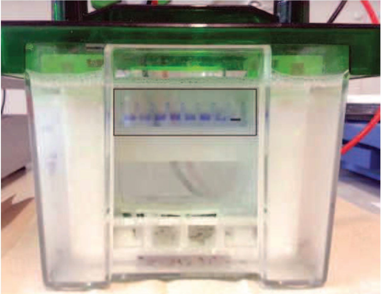
Abbildung 16. Proteinproben in Sammelgeltaschen auf einem Polyacrilamid Gel. Eigenes Foto. Die Proteinproben, durch Bromphenolblau dunkelblau gefärbt, befinden sich am Boden der hellblau gefärbten Sammelgeltaschen. Der Proteinmarker in der Geltasche ganz rechts.
