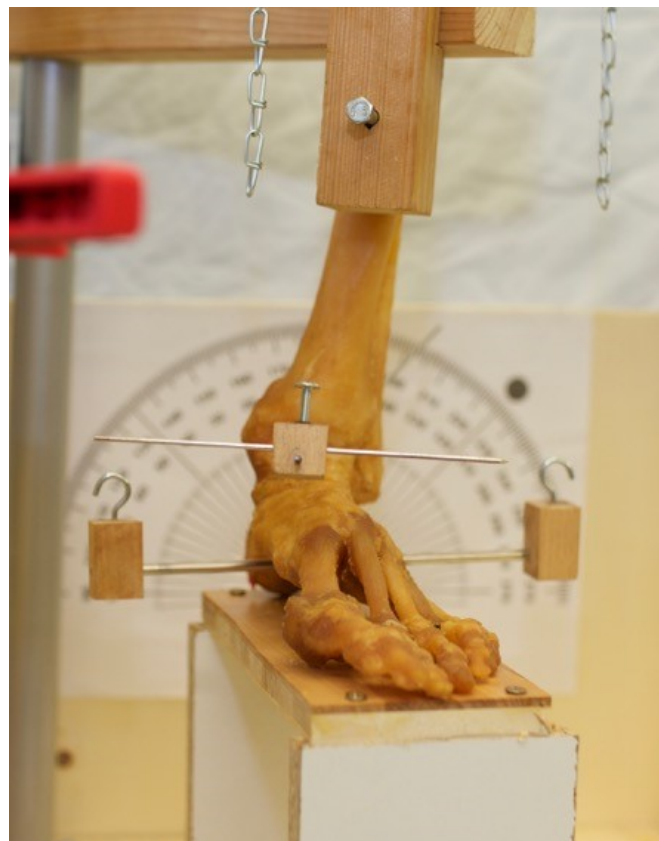
Abbildung 11: Gesetzte Drähte, Ansicht von frontal. Draht zur Bestimmung von Innen- bzw. Außenrotation
