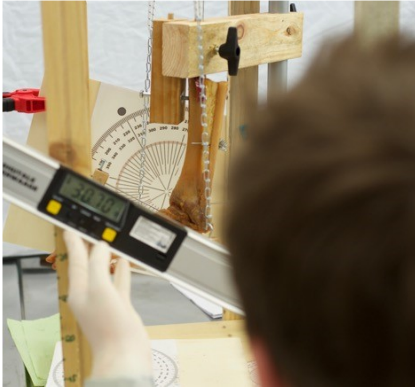
Abbildung 15: Messung mit digitaler Wasserwaage in Plantarflexion
