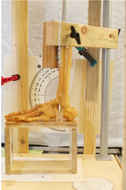
Abbildung 6: Positioniertes Präparat in Messapparat von lateral
