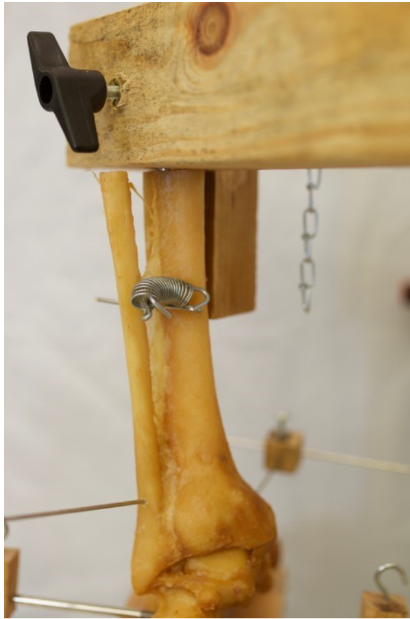
Abbildung 12: Aufspannen der Membrana Interossea mittels Feder
