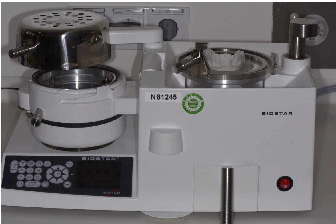
Abbildung 2: Druckformgerät BIOSTAR der Firma Scheu Dental an der Medizinischen Universität Graz
