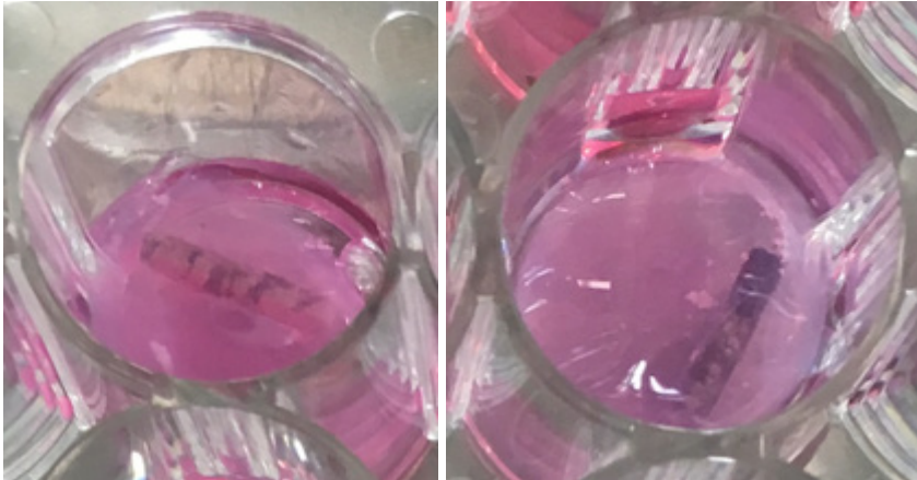
Abbildung 45: Die makroskopische Aufnahme an Tag 13 zeigt eine deutliche Degradation der Mg-Stäbe im 3D Gel mit osteogen diff. (li) und undiff. (re) Zellen; DonorIn 6 – Passage 3
