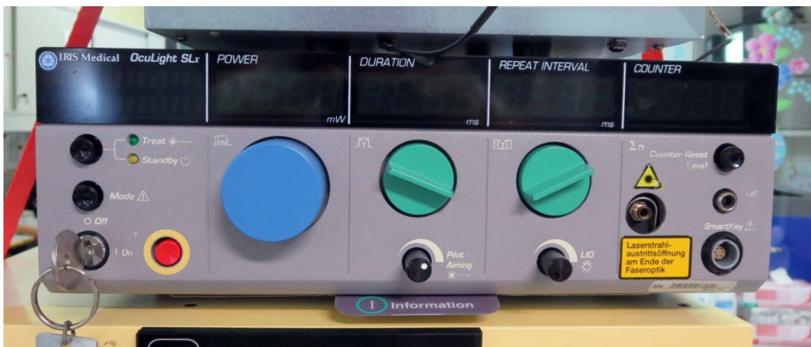
Abbildung 7 - Vorderansicht des Diodenlasers mit Drehknöpfen zur Einstellung von Energie, Dauer und Wiederholungsrate der Laserstrahlabgabe.
