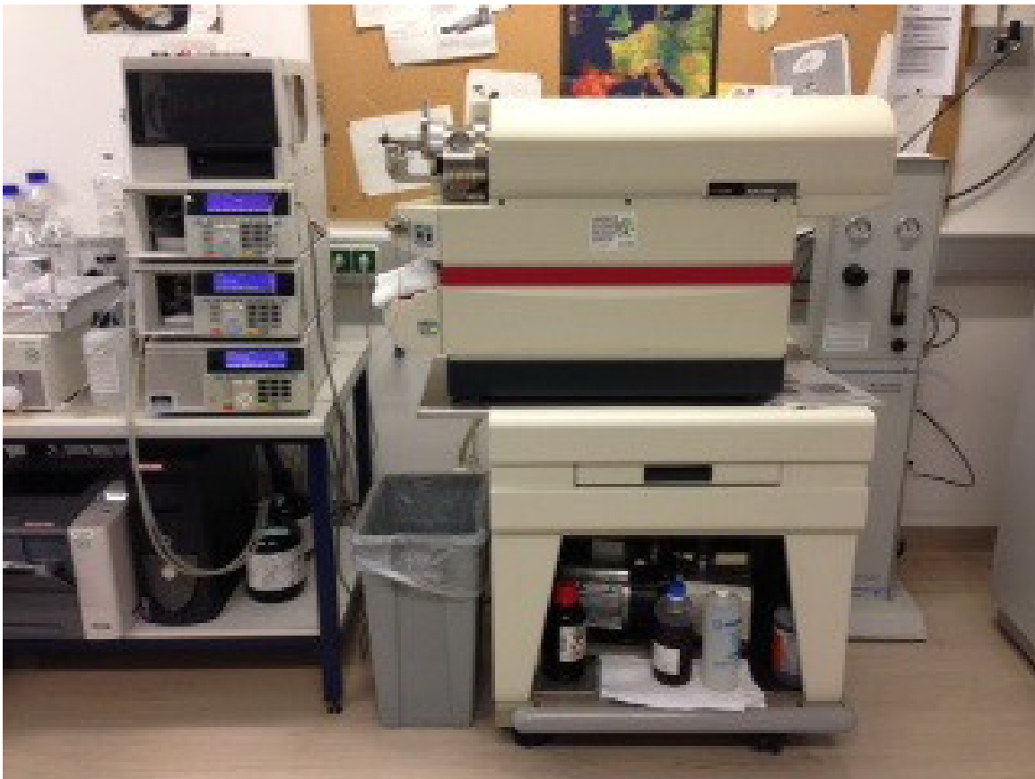
Abbildung 9: Bild eines Massenspektrometers. Standort: klinisches Institut für Medizinische und Chemische Labordiagnostik Universitätsklinikum Graz
