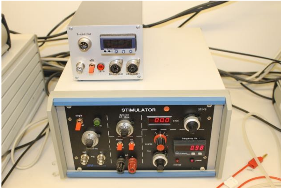
Abbildung 6 unten der Stimulator, oben das Thermostat
