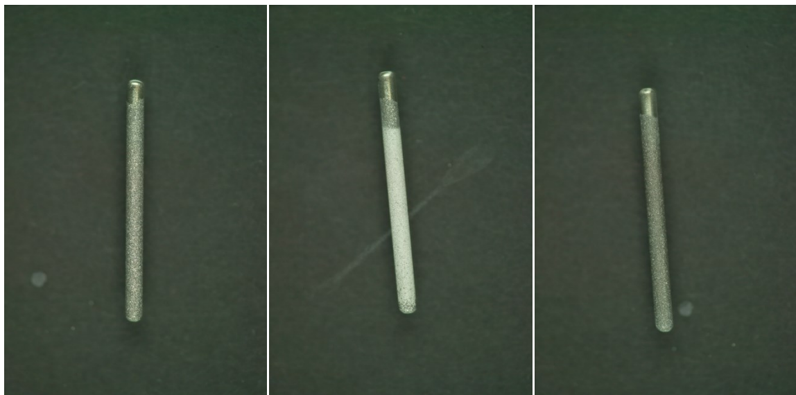
Abbildung 9: Die verwendeten Kirschnerdrähte mit GP-Beschichtung, nach Lufttrocknung nach der Elution im PBS-Puffer (bei der weißen Schicht handelt es sich um die Salzreste des Puffers), und nach der Elution in Methanolbad (v.l.n.r.)
