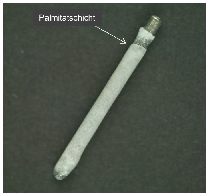
Abbildung 14: Kirschnerdraht nach dem Selbstbeschichtungsversuch. Man erkennt deutlich die dicke Schicht an Palmitat, welche die gesamte Oberfläche bedeckt.
