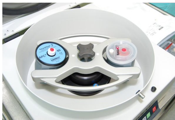
Abb. 47 BMAC- Zentrifuge mit venösem Blut im Zentrifugenröhrchen (blau) und Knochenmarkaspirat im PROCESS-Becher (rechts)
