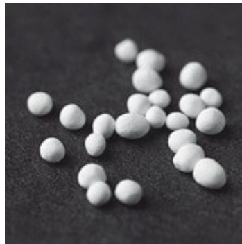
Abb. 27 Granula aus 60% HA und 40 % \beta -TCP mit einer Polyglykolidschicht ummantelt
