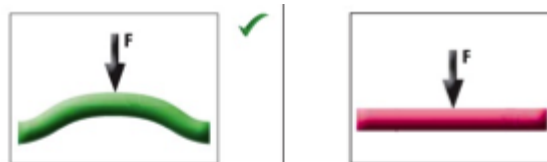
Abbildung 6: Umwandlung von Zug- in Druckspannung (Arnetzl G. , 2010)
