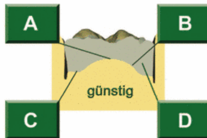
Abbildung 11 Günstige Faktoren der Pfeilerpräparation für vollkeramische Inlays und Teilkronen. A: konvexer Kavitätenboden führt zur Umwandlung von Zug- in Druckspannungen, B: große Radien zur Vermeidung von Kerbspannungen, C: keine abrupten Änderungen der Schichtstärke, D: einfache Formgebungen (Arnetzl & Arnetzl, 2011).
