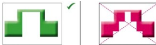
Abbildung 9: Einfache Formgebung statt komplizierter Wandgebung (Arnetzl G. , 2010)
