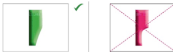
Abbildung 8: Kontinuierliche statt plötzliche Querschnittsveränderungen (Arnetzl G. , 2010)
