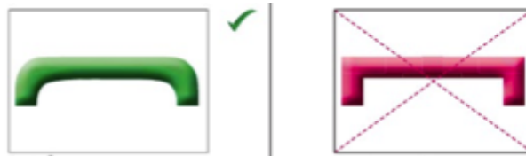
Abbildung 7: Runde Übergänge um Kerbspannungen zu vermeiden (Arnetzl G. , 2010)
