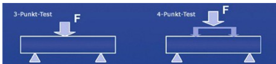
Abbildung 3 Schematische Darstellung des 3-Punkt- und 4-Punkt-Biegeversuchs nach DIN EN 843-1. Höhere Werte werden in der Regel beim 3-Punkt-Biegeversuch erzielt (Greitens, 2009).
