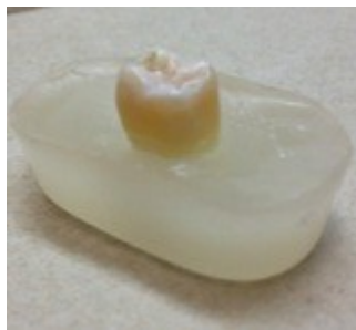
Abbildung 12: In Kunststoff eingebetteter und an allen vier Schmelzflächen präparierter Zahn vor der Klebung.
