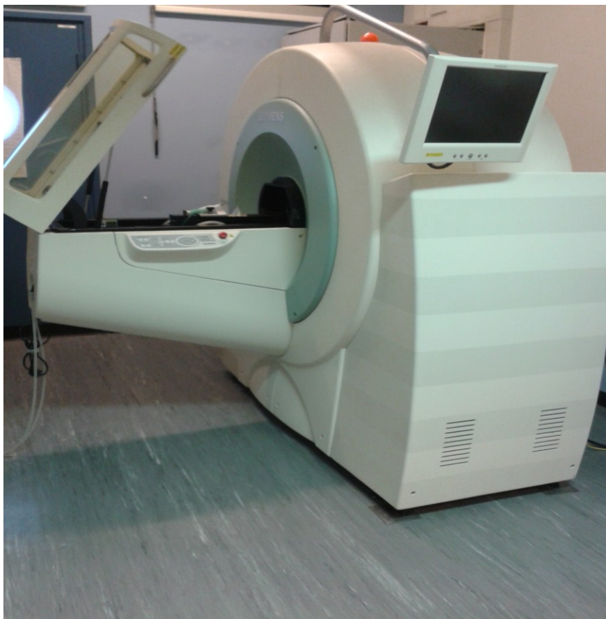
Abb.2 Micro Computertomograph für Kleintiere
