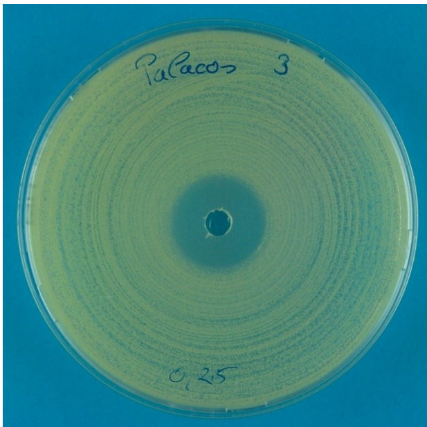
Abbildung 6: Elutionstest mit dem 0,25-Stunden-Eluat von Palacos® R+G. Im Zentrum das mittels Pasteur-Pipette gestanzte Loch. Kreisförmige Wachstumshemmung von Staphylococcus aureus durch Gentamicin.
