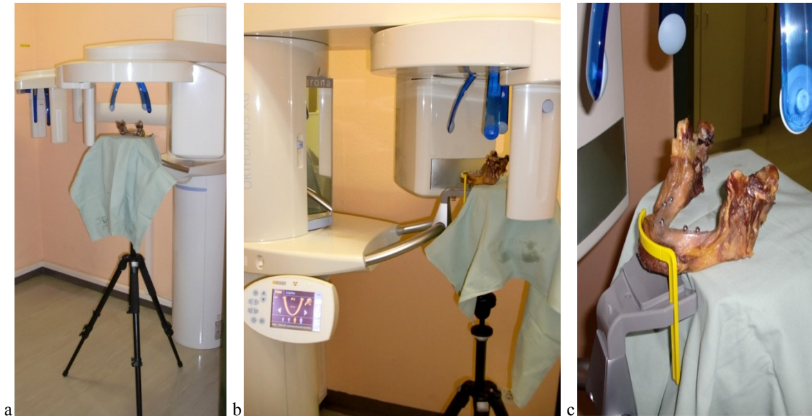
Abbildung 24 OPG Aufnahme Mandibula: Orthophos XG Plus der Firma Sirona, a/b/c: UK+Kugelschablone in Röntgenposition auf der Schaumstoffhalterung
