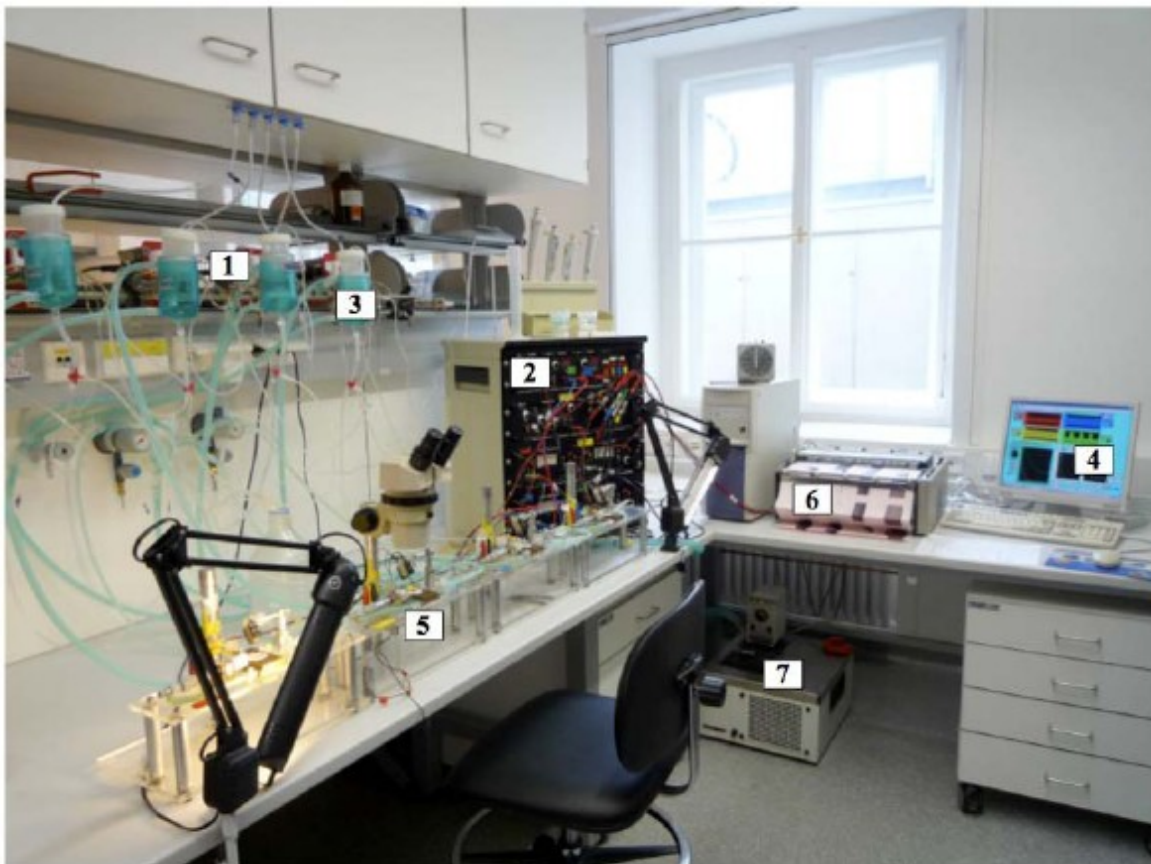
Abbildung 7: Anlage zur Messung der isometrischen Kontraktion: (1) Rollenpumpe, (2) Stimulationseinheit, (3) Vorratsgefäße, (4) Computerkontrolleinheit, (5) Organbäder, (6) Thermo-schreiber, (7) Heizung und Thermostat.
