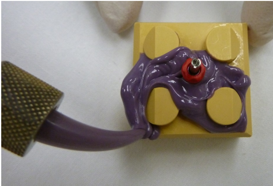
Abbildung 13: Umspritzen der blasengefährdeten Stellen mit Impregum™Penta™ mittels Penta™ Elastomerspritze
