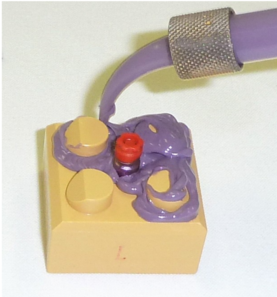
Abbildung 6: Umspritzen der blasengefährdeten Stellen mit Impregum TM Penta TM mittels Penta TM Elastomerspritze
