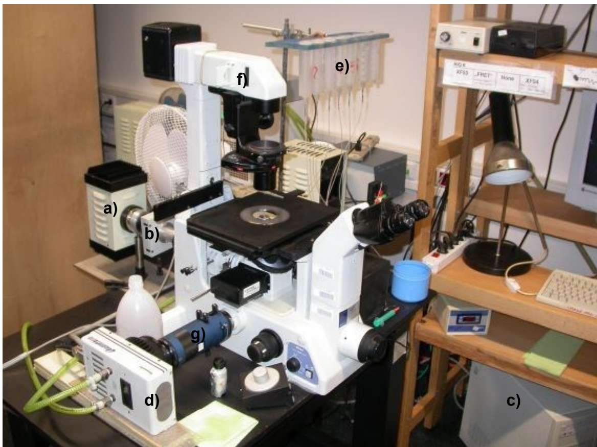
Abbildung 10: Fluoreszenzmikroskop mit Ausstattung: a) Lichtbogenlampe b) Filterrad zur Auswahl der Anregungswellenlänge c) PC zur Steuerung und Bildverarbeitung d) flüssigkeitsgekühlte Kamera e) Perfusionsystem f) Lampe für Weitfeldmikroskopie
