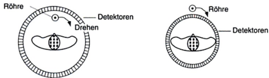
Abbildung 5: Aufbau eines CT-Scanners der 4. Generation [3 S. 115]
