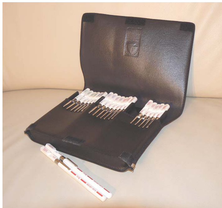
Abbildung 5 Das aus 20 Mono-filamenten bestehende Von-Frey-Filament-Set, welches während der Studie verwendet wurde.
