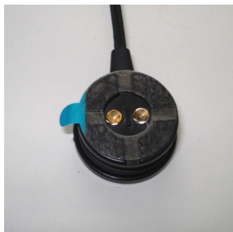
Abb. 2.6: Optischer (IR)-Sensor mit Klebering
