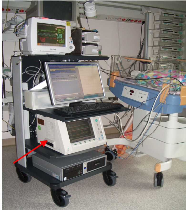
Abbildung 3: Versuchsanordnung – der NIRO 300 (Hamamatsu Photonics, Japan) ist mit einem roten Pfeil gekennzeichnet.
