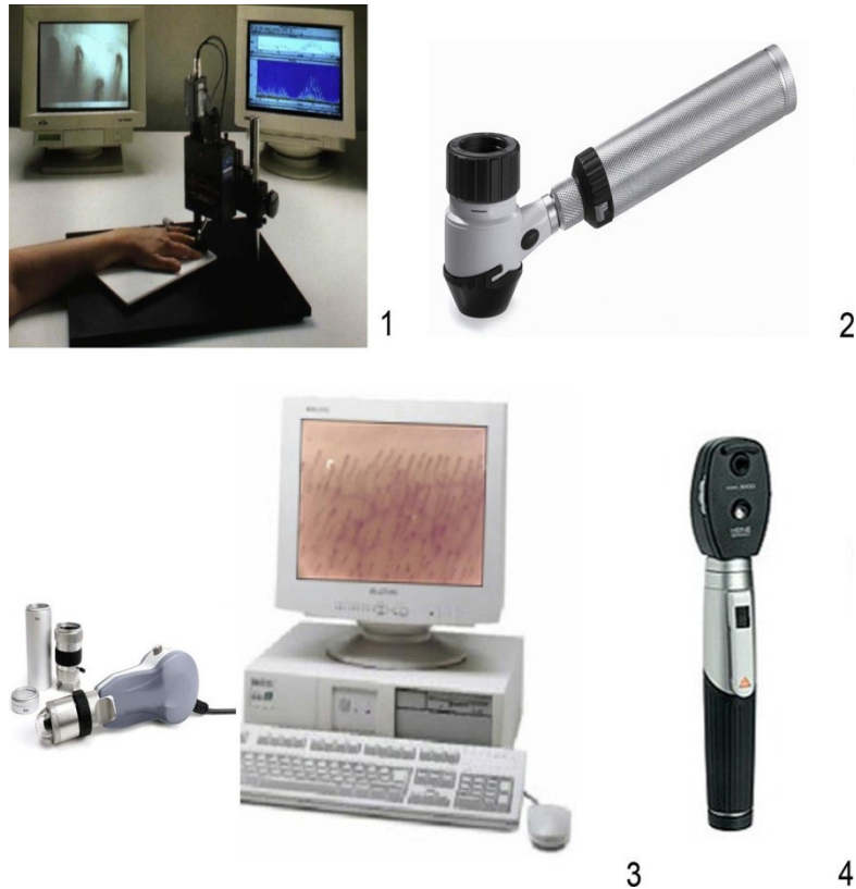
Abbildung 2: Verschiedene Geräte für die kapillarmikroskopische Analyse; Bildnummer 1- 3; (1) Weitsicht – Mikroskop, (2) Dermatoskop, (3) Videokapillarmikroskop (50) (4) Ophthalmoskop (Heine Mini Ophthalmoskop ®, DE, Heine)
